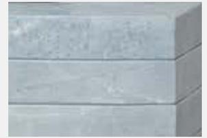
Massiver Speckstein zur Wärmespeicherung
